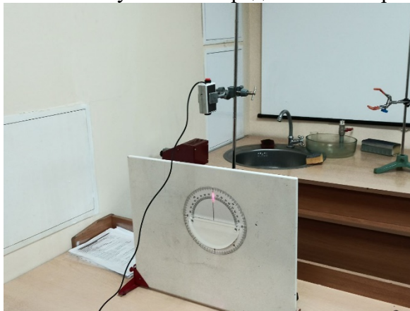
Рис.1. Экспериментальная установка для исследования зависимости величины коэффициента преломления от плотности вещества
